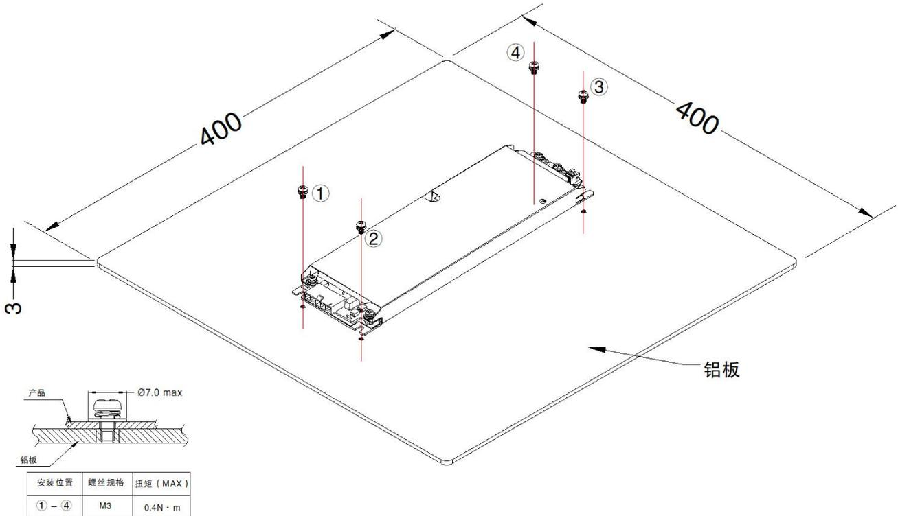
注: 1. 为了满足“降额曲线”, 产品必须安装在铝板上进行测试, 铝板建议尺寸如图所示, 同时为了保证导热性能, 需在产品底部涂抹导热硅脂。
